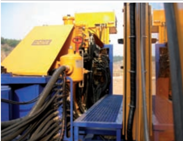
zentraler Wartungsgang / maintenance walk
